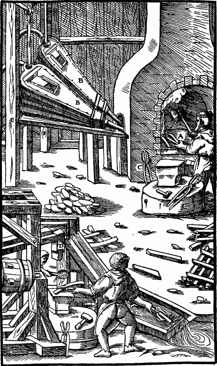
Das Frischfeuer A. Die Blasebälge B. Die Zangen C. Der Hammer D. Das fließende Wasser E.
