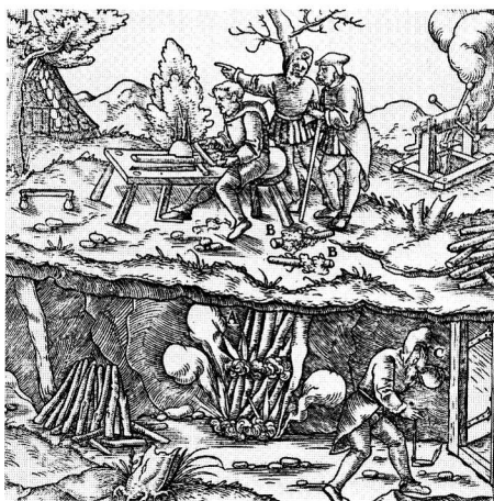
20 Feuersetzen nach Agricola, 1546.
